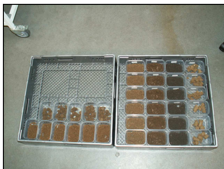
Figur 7 Jordprøver, udtaget med kernehusudstikker, klar til knusning
