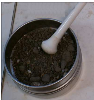
Figur 5 Sigtning gennem 2 mm sigte
